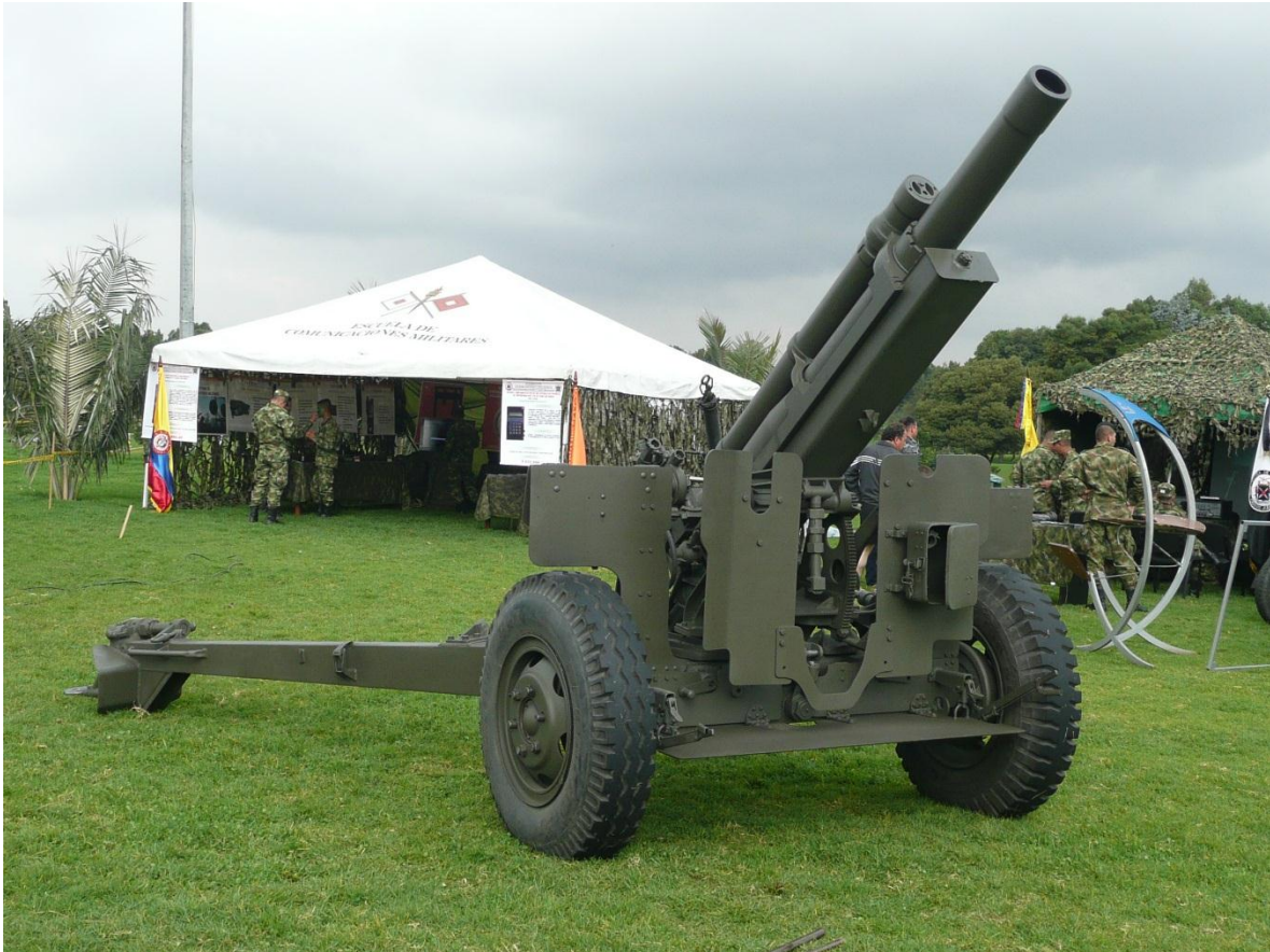
Obús remolcado M-101A1 de 105 mm. de origen estadounidense, al servicio del Ejército Nacional de Colombia.
